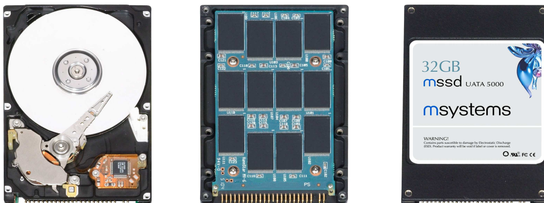
Rys. 4.51. Porównanie dysku HDD z SSD 10
