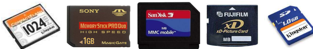
Rys. 4.50. Przykłady kart pamięci flash: Compact flash, Memory stick, MMC(MultiMedia Card), xD (picture card), SD (secure Digital)
