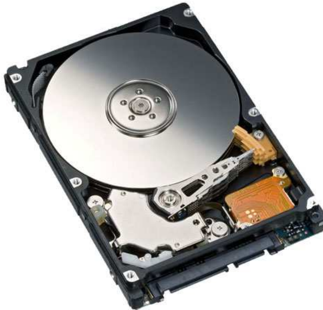
Rys. 4.47. Współczesny dysk twardy (2,5”) przeznaczony dla komputerów przenośnych klasy notebook 7
